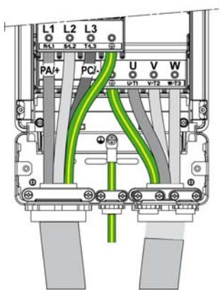
**注意：** PA/+ 和 PC/- 端子仅用于测量直流母线电压，且不适用于接线后供外部使用。
