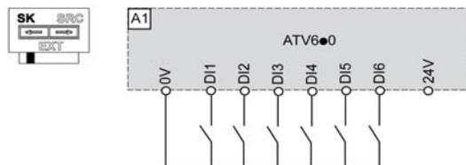
切换设置为 EXT (外部) 位置, 将使用外部电源给逻辑输入供电
