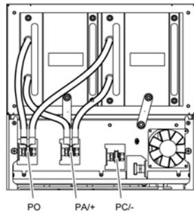
**注意：** PA+/ 和 PC/- 端子仅用于测量直流母线电压，且不适用于接线后供外部使用。
