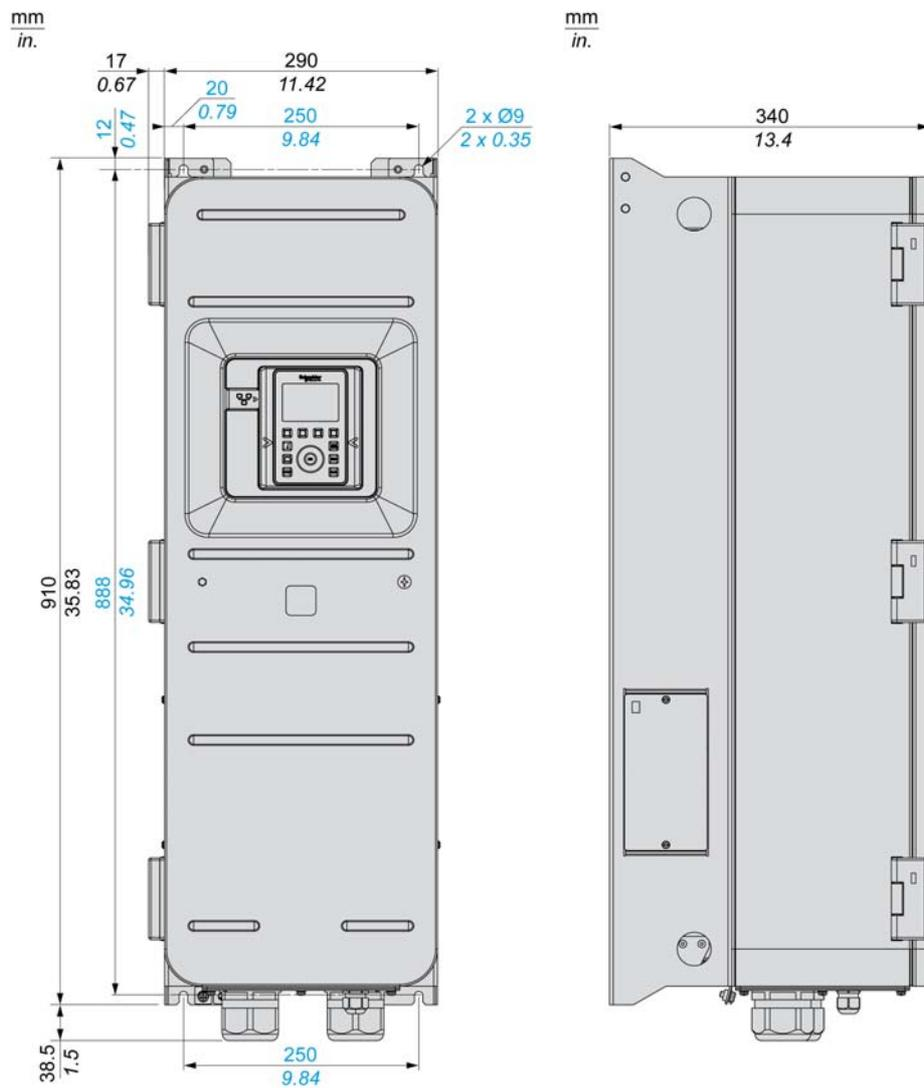
带负载开关的 IP55 / UL 类型 1 变频器 - 前视图与侧视图
