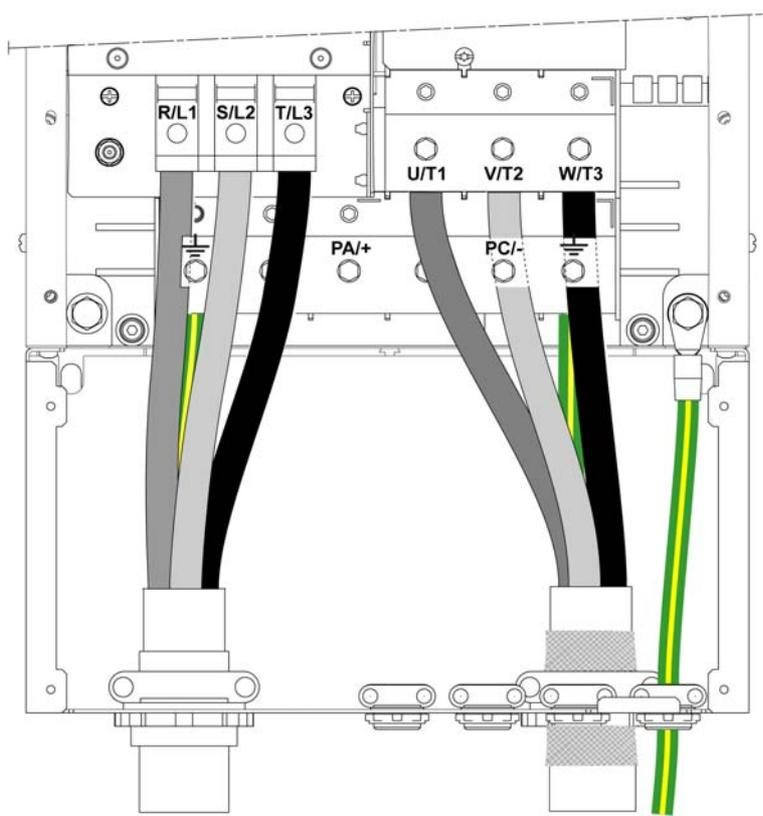
**注意：** PA/+ 和 PC/- 端子仅用于测量直流母线电压，且不适用于接线后供外部使用。
