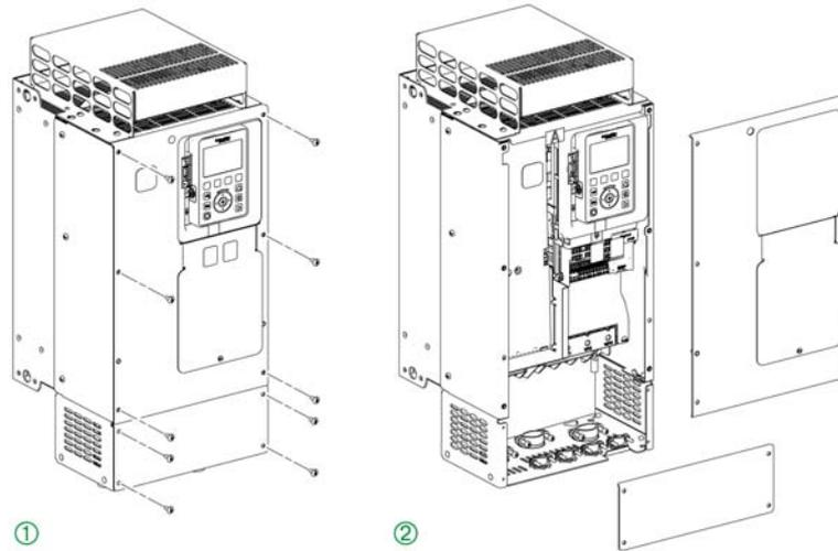
按照下列说明接入机架尺寸为 3S 和 5S 的变频器上的端子
