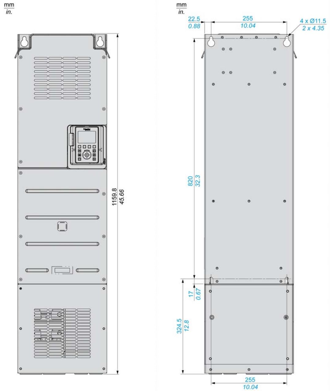
**注意：** 下方导线接线盒单独销售。此零件可将产品安装在墙上。并使底部为 IP21 防护等级和 UL 1 型防护等级。
