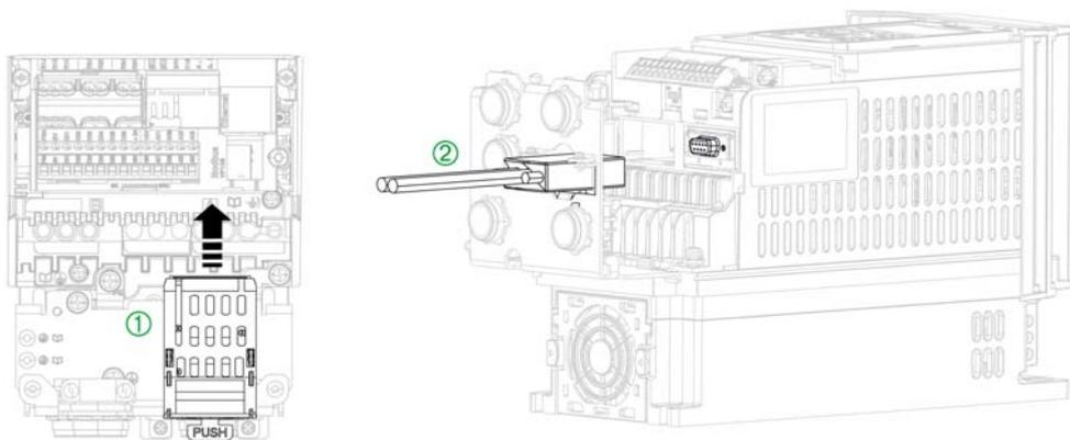
为帮助确保对控制部分正确接线，请遵循以下操作说明来在机架尺寸为 1 的变频器上安装 PROFIBUS 现场总线模块。
