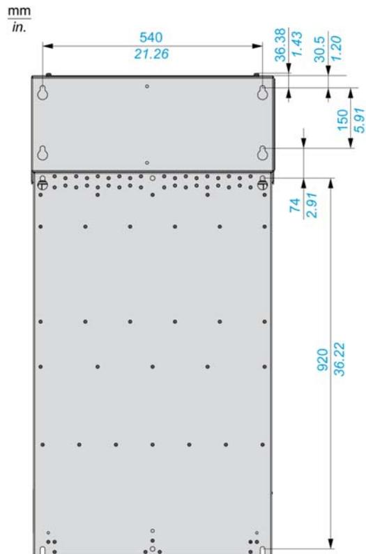
**注意：** 下方导线接线盒单独销售。此零件可将产品安装在墙上。并使底部为 IP21 防护等级和 UL 1 型防护等级。
