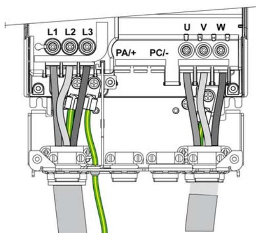
**注意：** PA/+ 和 PC/- 端子仅用于测量直流母线电压，且不适用于接线后供外部使用。
