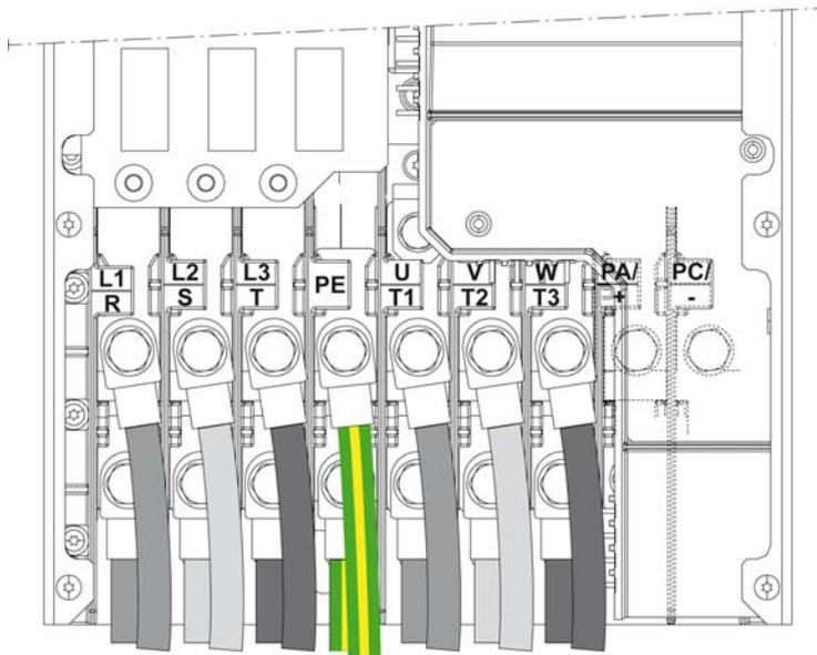
**注意：** PA/+ 和 PC/- 端子仅用于测量直流母线电压，且不适用于接线后供外部使用。
