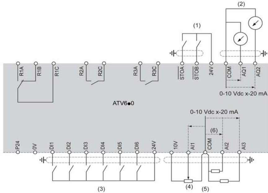
(1) STO 安全扭矩关闭, (2) 模拟输出, (3) 数字输入, (4) 参考电位计 (如SZ1RV1002), (5) 模拟输入
