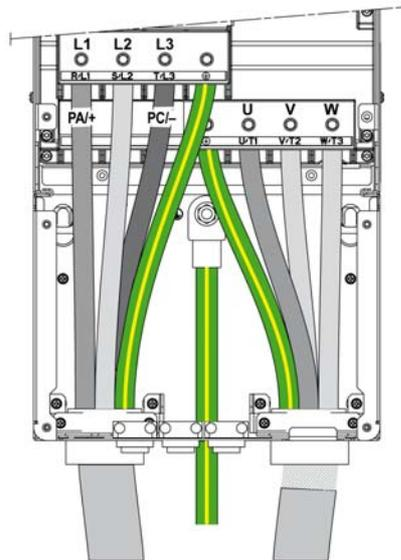
**注意：** PA/+ 和 PC/- 端子仅用于测量直流母线电压，且不适用于接线后供外部使用。
