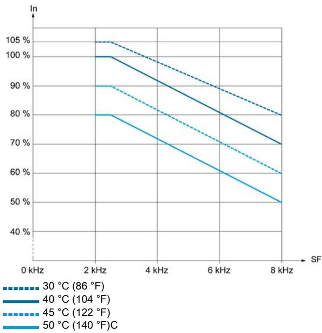
落地式变频器 - 所有机架尺寸 - 380...440 V - 重载
