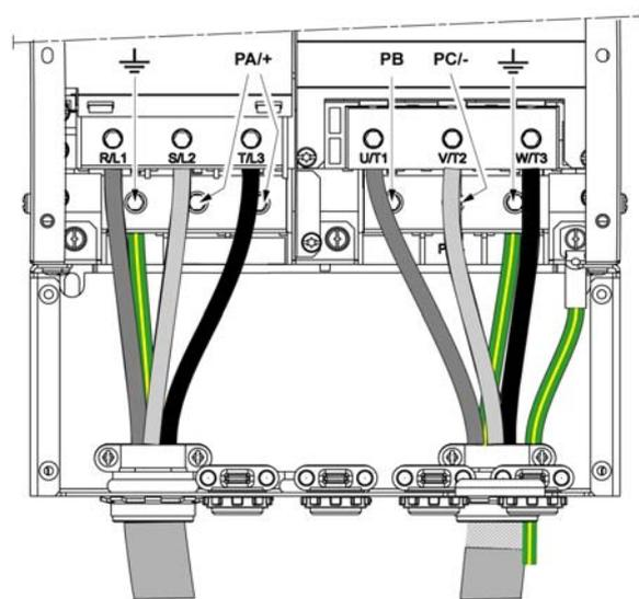
**注意：** PA/+ 和 PC/- 端子仅用于测量直流母线电压，且不适用于接线后供外部使用。
