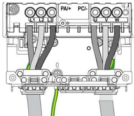
**注意：** PA/+ 和 PC/- 端子仅用于测量直流母线电压，且不适用于接线后供外部使用。
