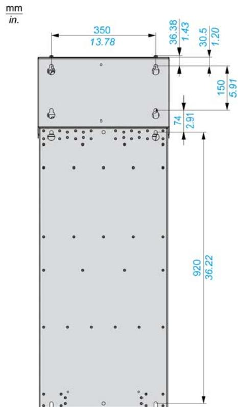
**注意：**下方导线接线盒单独销售。此零件可将产品安装在墙上。并使底部为 IP21 防护等级和 UL 1 型防护等级。
